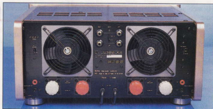
Gut geschützt: Zwei kräftige Lüfter bewahren die Halbleiter vor dem Hitzschlag. Im Schnellgang laufen die Ventilatoren aber recht laut.
