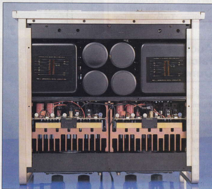
Strikt getrennt: Im gemeinsamen Gehäuse vereint der Luxman zwei Monoendstufen. Jeder Kanal hat aber ein eigenes Netzteil und sogar die Klemmen für ein eigenes Netzkabel an der Gehäuse-Rückwand.
