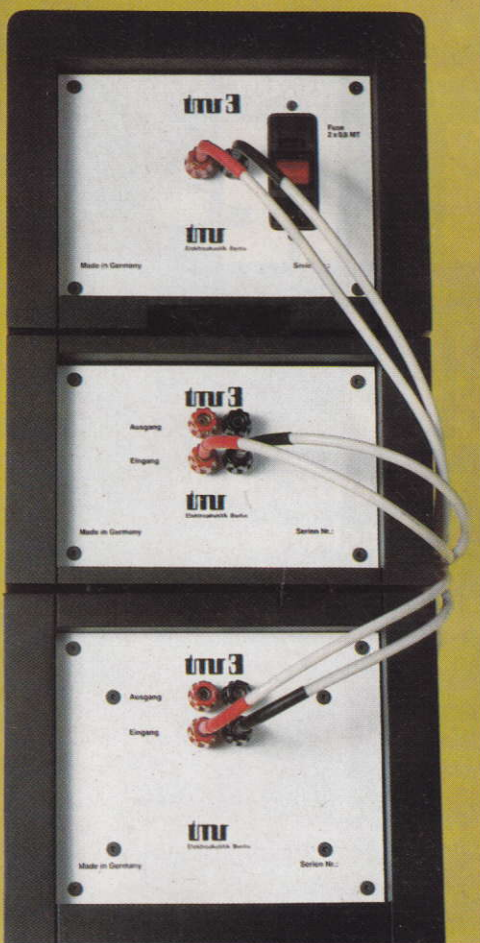
Teile und herrsche: Die Anschlußterminals der TMR 3 erlauben Tri-Wiring oder gar Tri-Amping.
