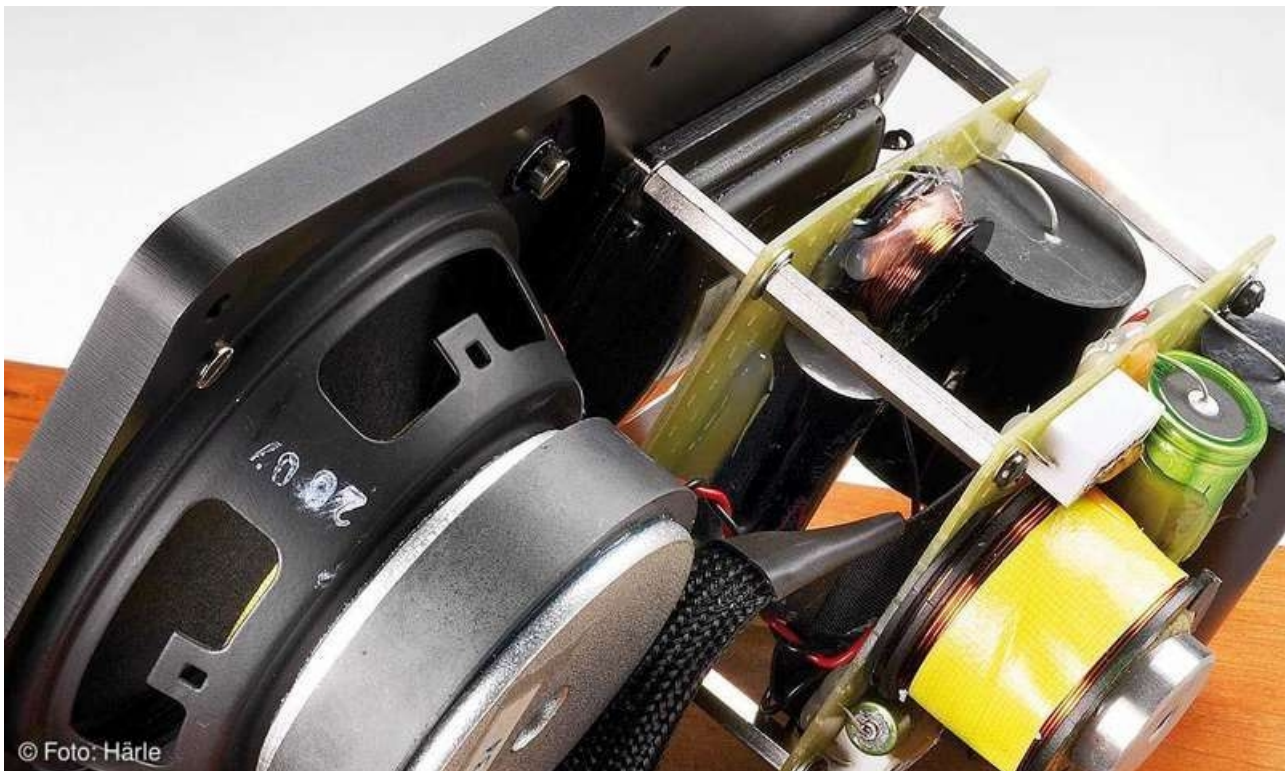
Hinter dem Magnetstaten sitzen die Weichenzweige für Mittel- und Hochtonzweig.
